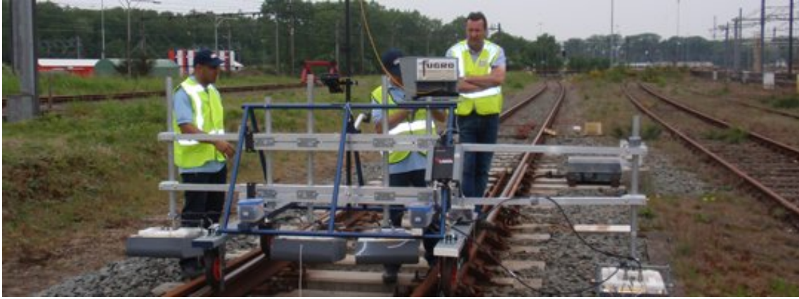
Рис. 1 Георадар встановлений на спеціальному візку, що переміщується по рейках
