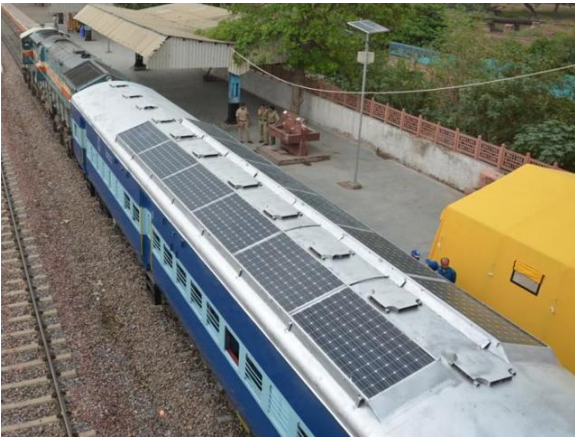
Рис. 3. Перший індійський поїзд з сонячними батареями на даху
