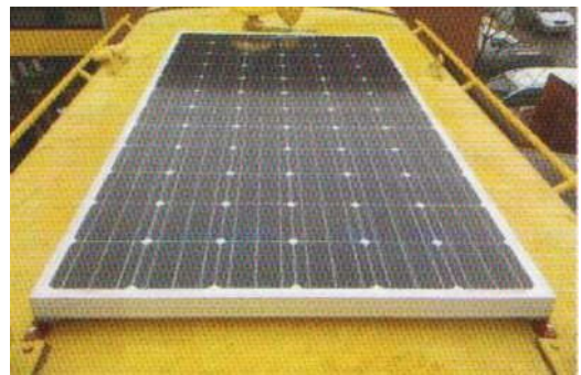
Рис. 2. Сонячні панелі встановлені на даху тепловоза Janine
