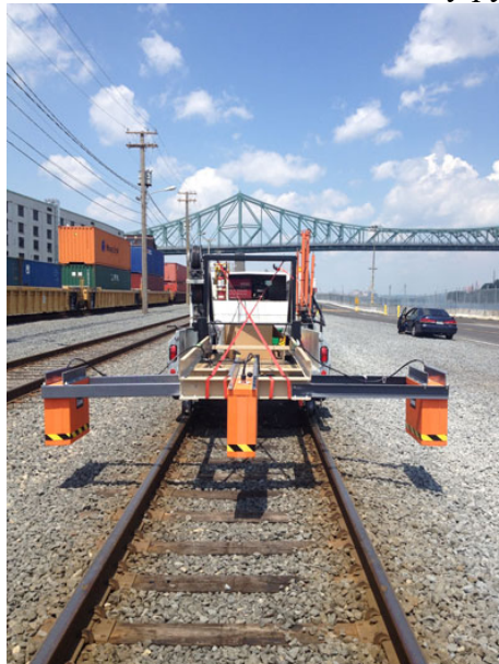
Рис.3 Георадар встановлений на автомобілі, що переміщується по колії
