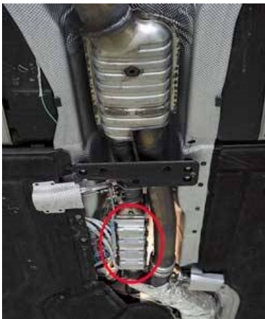
Рис. 5. Технологія перетворення теплової енергії вихлопних газів в електричну на основі ефекту Пельтьє
