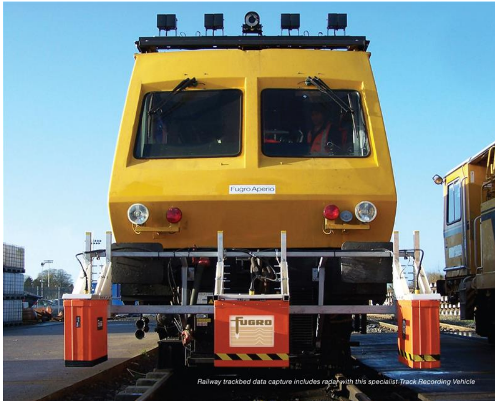
Рис.2 Георадар встановлений на самохідному рухомому складі
