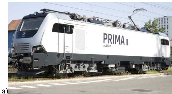
Рис. 7 – Електровоз Alstom Prima II (а) та загальний вигляд його візка (б)
