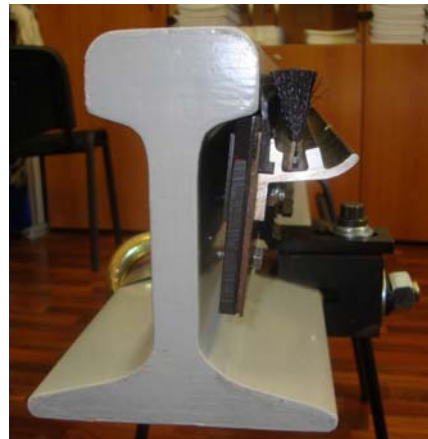
Рис. 5 - Кріплення змащувальної шини до рейки
