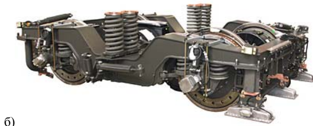
Рис. 8 – Електровоз Siemens Vectron (а) та загальний вигляд його візка (б)
