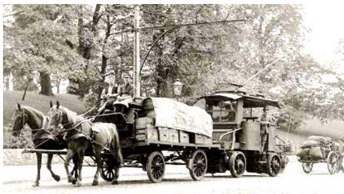
Рис. 2 – Гібридна кінно-тролейбусна лінія. Гамбург, 1914 рік.
