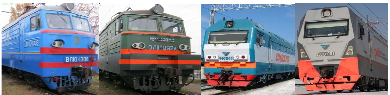
Рис. 1 магістральні електровози: ВЛ10, ВЛ11м, 2ЭС6, 2ЭС10
