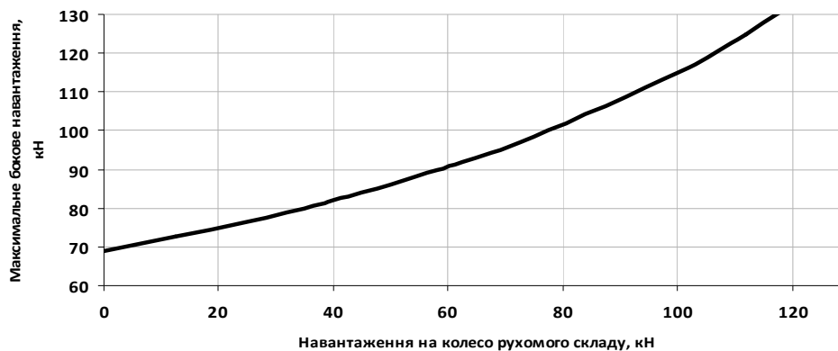
Рис.1 – Взаємозв'язок максимального бокового навантаження від навантаження на колісну пару
