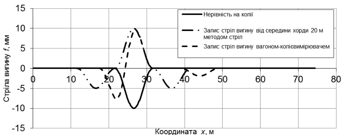
Рисунок 4 – Моделювання записів стріл вигину для нерівності на колії довжиною 10 м
