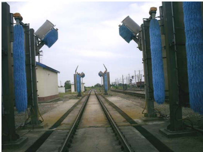
Рис. 2. Обладнання існуючого мийно-очищувального комплексу
