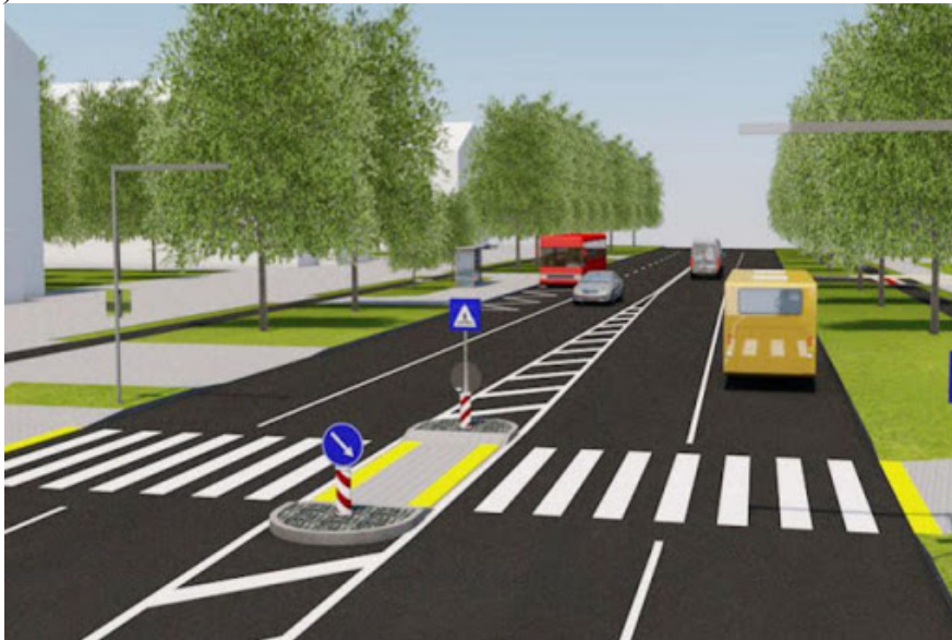
Рис. 4. Устройство островка безопасности
