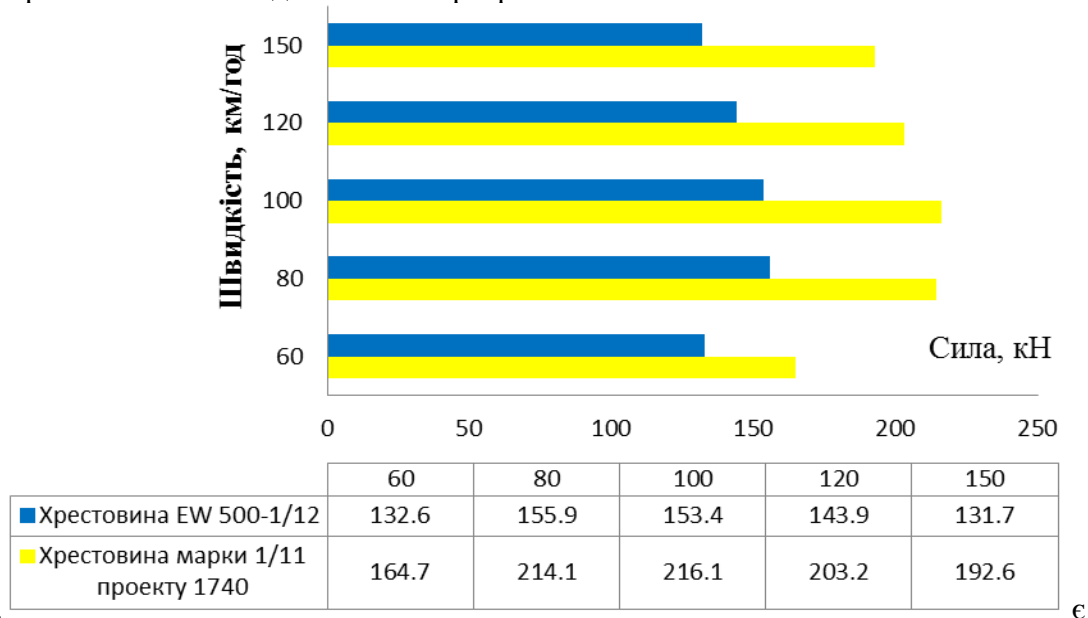
Рис.1 Порівняння напружень у підшві хрестовин при дії колеса на хрестовину EW 500-1/12 та хрестовину марки 1/11 проекту 1740
