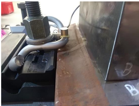
Рис.1. Дослідження тріщиностійкості проміжного рейкового скріплення Schwinag
